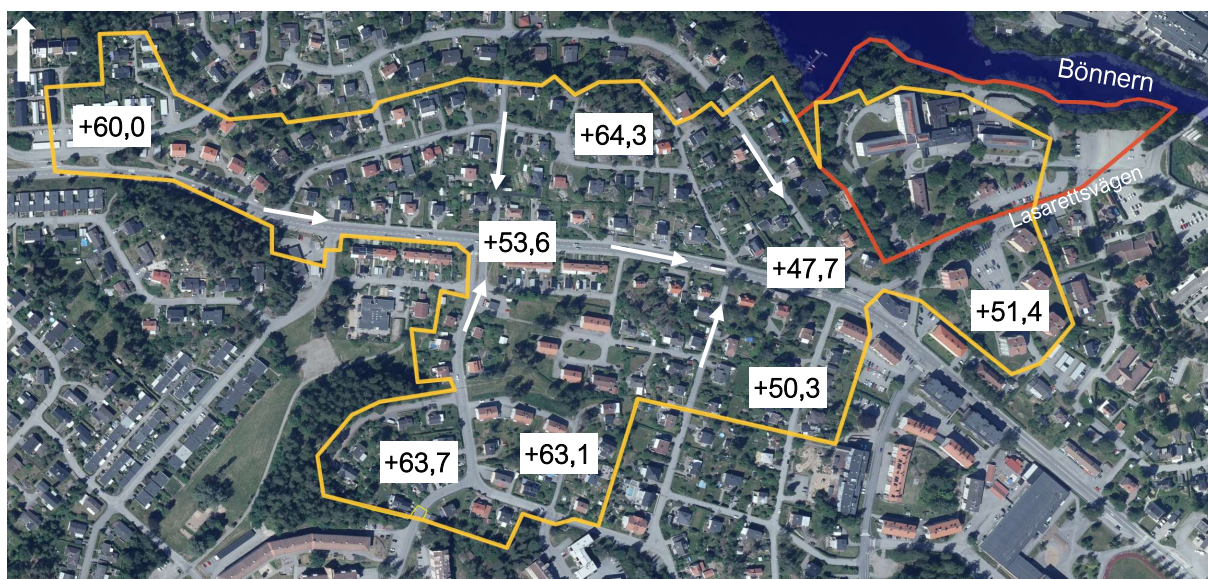
Figur 1. Översiktsbild med befintliga marknivåer, planområdet (röd markering), avrinningsområdet (gul markering) samt recipient Bönnern, SCALGO
